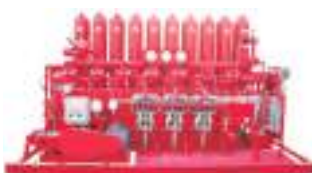
Accumulator Unit Станция управления ПВО
